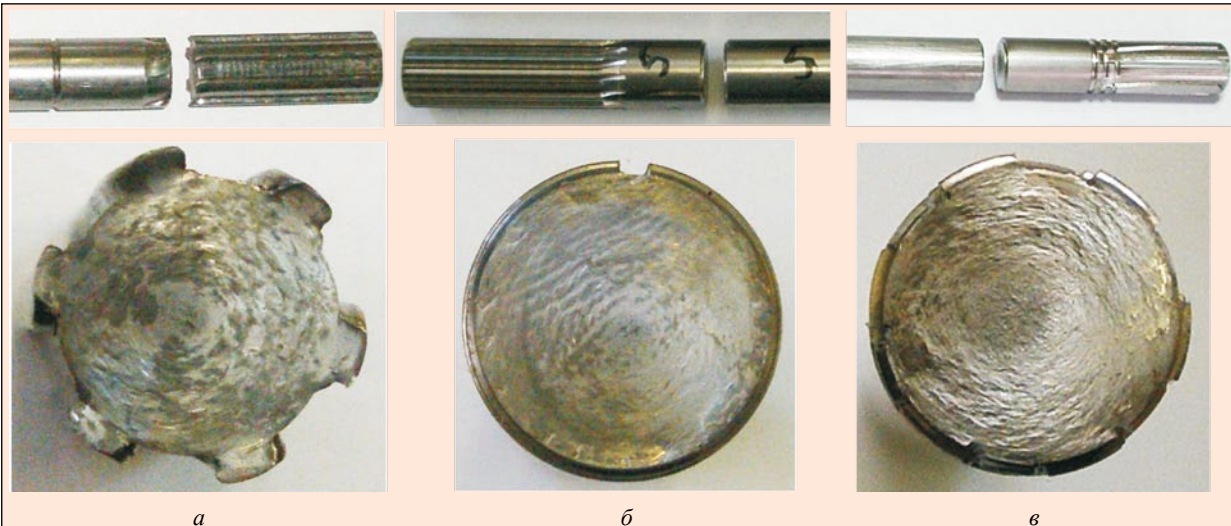
Рис. 5. Характер разрушения валов с различными шлицевыми соединениями: а – с прямобочными; б – с эвольвентным; в – с прямобочным низкопрофильным
