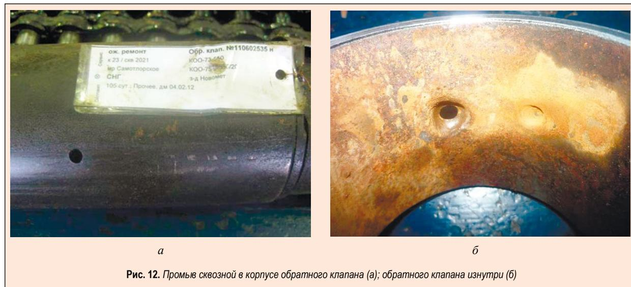
Рис. 12. Промыв сквозной в корпусе обратного клапана (а); обратного клапана изнутри (б)
