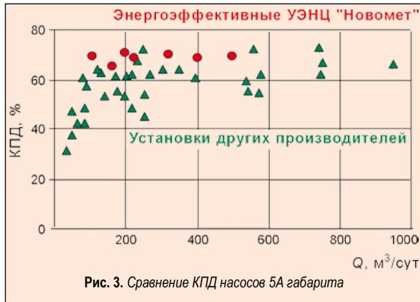
Сравнительные данные КПД и потребляемой мощности рабочей ступенью ЭЦН разных производителей
