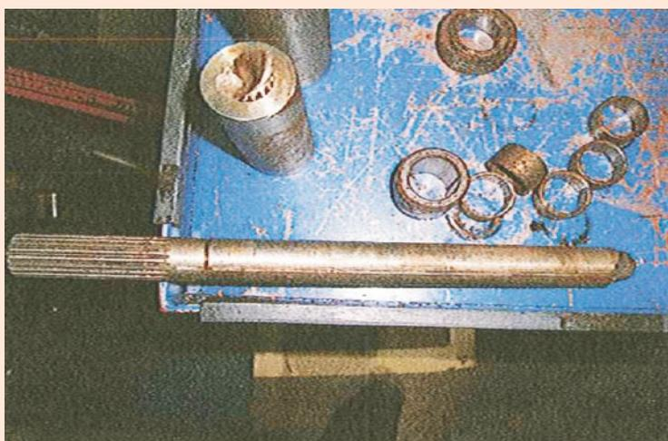
Рис. 10. Слом вала входного модуля
