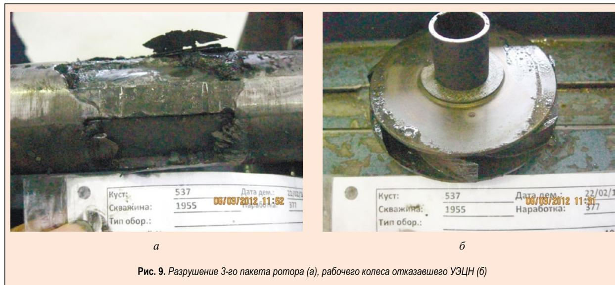
Рис. 9. Разрушение 3-го пакета ротора (а), рабочего колеса отказавшего УЭЦН (б)
