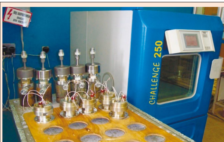
Рис. 3. Заводские испытания погружных блоков ТМС
