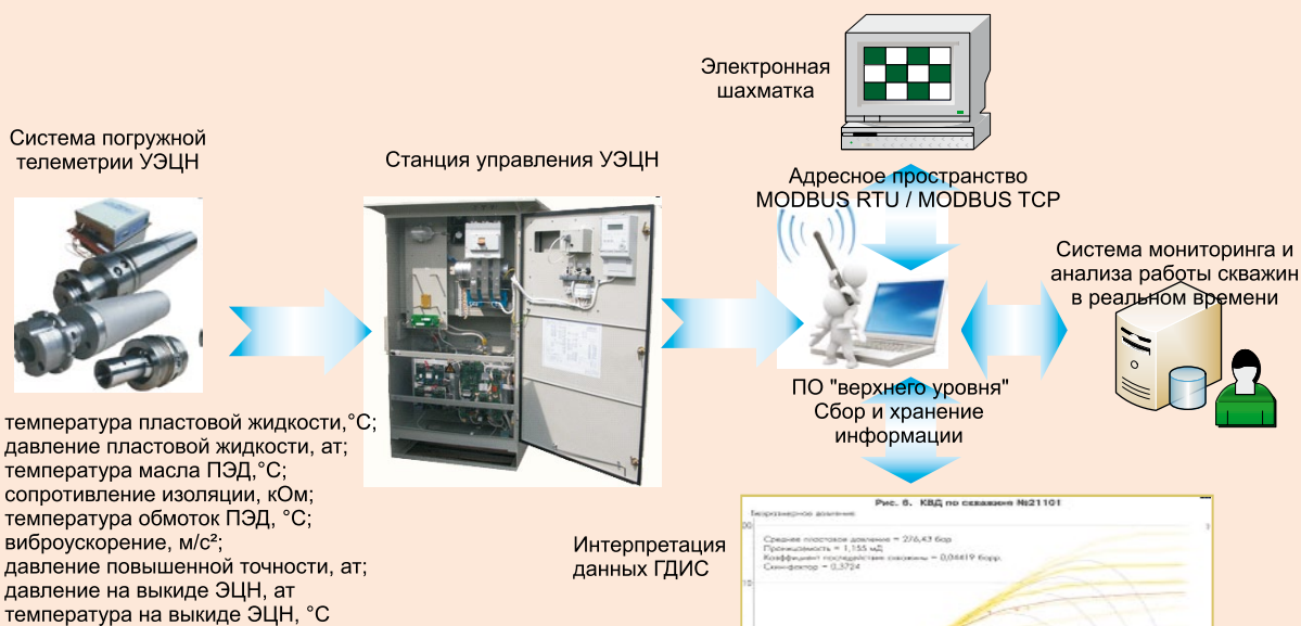
Рис. 6. Компоновка УЭЦН, оснащенной системой погружной телеметрии с дополнительным блоком на выкиде электроцентробежного насоса
