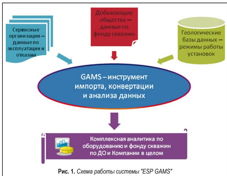
Рис. 1. Схема работы системы "ESP GAMS"
