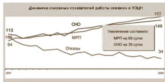
Рисунок 10. Динамика основных показателей работы скважин, оборудованных установками ЭЦН.
